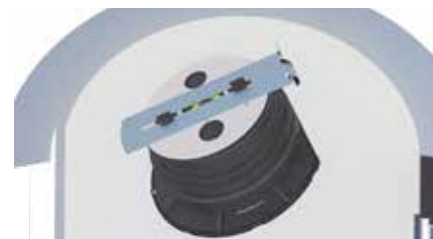
3. Umístěte SUPACLPP kolmo ke stěně.
