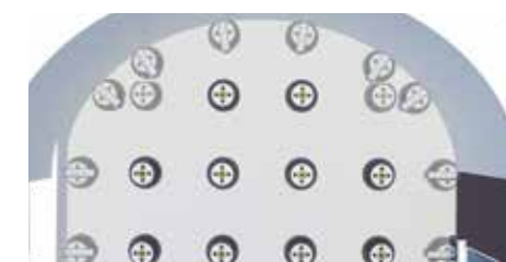
13. Umístěte terče do pozic vyznačených na schématu rozvržení.
