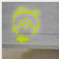
D4. Uřízněte dlaždici. Rozměr dlaždice se rovná vzdálenosti mezi profilem BSJ a spodním klipem SUPACLPB.
