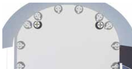
11. Umístěte terče do pozic vyznačených na schématu rozvržení.
